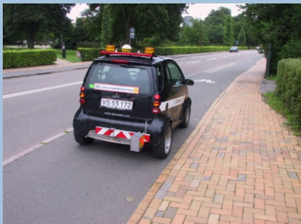
Lasermålinger af cykelstier i Odense foretages ved hjælp af en lille målevogn
